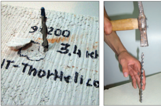
Фото 5–6. Испытания спиралевидных ремонтных связей в образцах из ячеистого бетона
